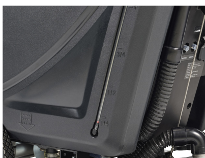
Indicateur du niveau de l'eau
